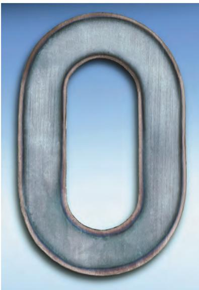
Abbildung 3: Längsschnitt durch ein einsatzgehärtetes Kettenglied.
