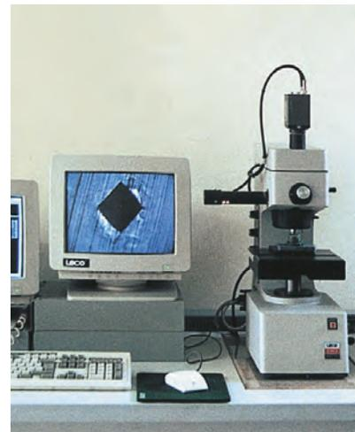
Abbildung 9: Härteprüfautomat (Archivierung der Härtewerte inklusive der Härteverlaufskurven)
