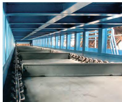
Abbildung 62: HEKO Ketten, Kratzer und Befestigungen im Untertrum
