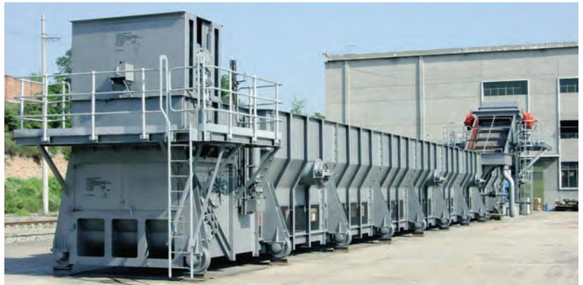
Abbildung 60: Nassentaschungsanlage
