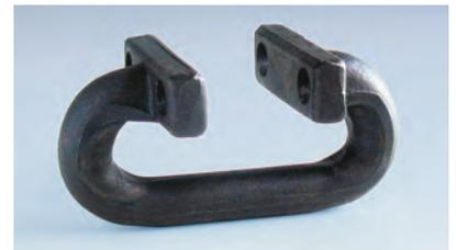
glieder sind hochverschleißfest gehärtet. Die quergestellten Befestigungslaschen haben je 2 Bohrungen zur Mitnehmerbefestigung. Die Befestigungsglieder Typ BGQ sind auch in anderen Stahl-Qualitäten und Abmessungen erhältlich.
