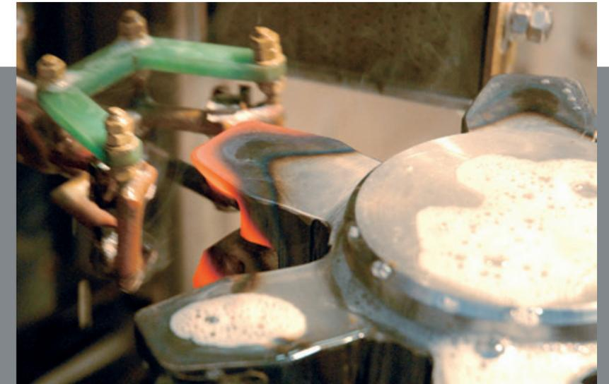
Randschichthärten ist das örtlich begrenzte Erwärmen (Austenitisieren) und Abschrecken von Bauteilen. Bei der induktiven Erwärmung wird durch mittel- oder hochfrequenten elektrischen Wechselstrom über einen an die zu härtende Kontur angepassten Induktor ein Induktionsstrom im Werkstück erzeugt, wodurch die Wärme entsteht und der Härtungsprozess eingeleitet wird.
