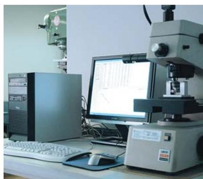
Automatische Kleinlasthärteprüfung nach Vickers
