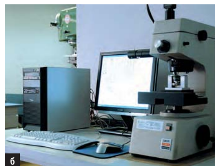
Рис. 3. Контроль качества продукции: а) магнитная дефектоскопия ковового звена, б) автоматическое тестирование твердости по Виккерсу
