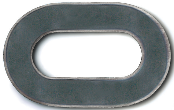
Längsschnitt durch ein einsatzgehärtetes Kettenglied
