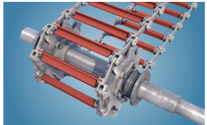
Doppelstrang-Gabellaschenkette mit montierten Mitnehmern für ansteigende Förderung
