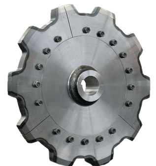
Kettenrad mit austauschbaren Zahnsegmenten und vergrößertem Zahnstückspiel
